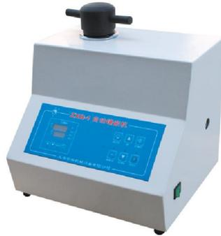
ZXQ-1 自动金相岩相试样镶嵌机，是样件镶嵌、磨抛前一道工序，对于微小并不易手拿或不规则的金相岩相试样进行镶嵌。经镶嵌后便于对试样进行磨抛操作也有利于在金相显微镜下正常地观察材料的组织。
